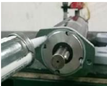
Fig. 9: Pasta de junta en la junta de papel.
