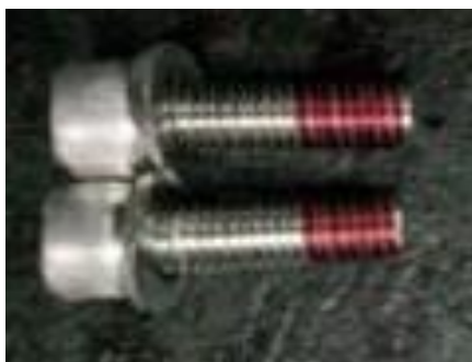
Fig. 12: Tornillos allen con arandela y Loctite preparados para montar.
