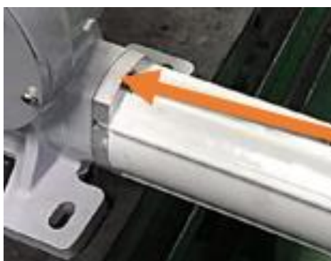
Fig. 11: Insertar motor DC.
