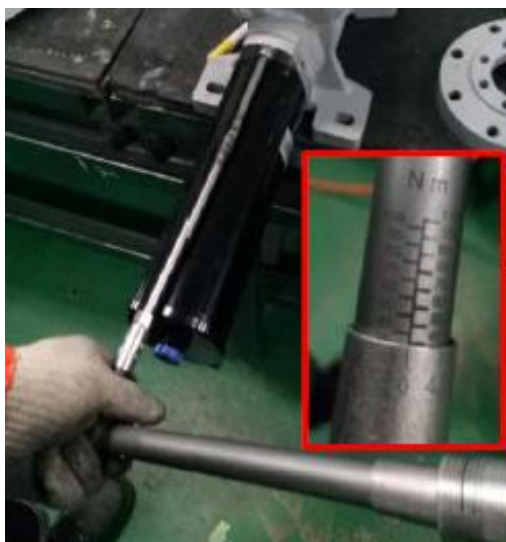
Fig. 14: Apriete de los tornillos al par requerido.
